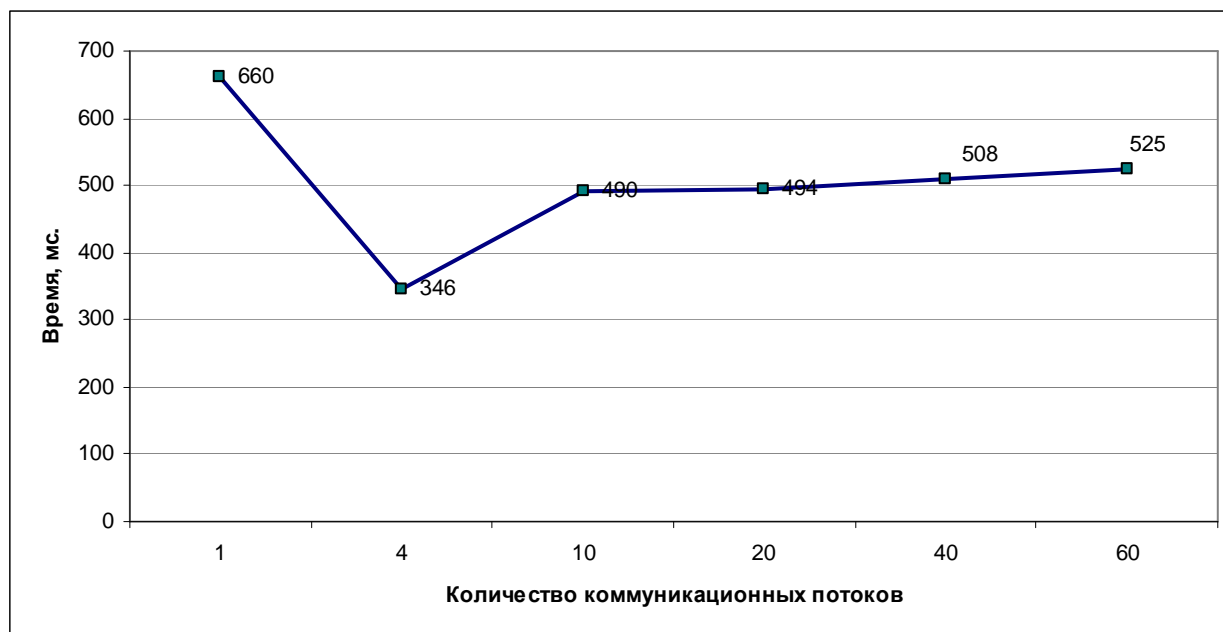
Рисунок 4. Зависимость времени выборки через TCP/IP от количества коммуникационных потоков
